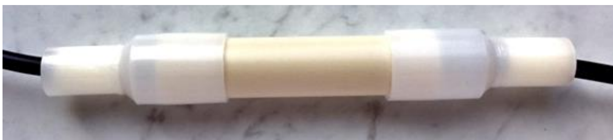
Bild 5. Det färdiga tätningsdonet runt kontakterna
