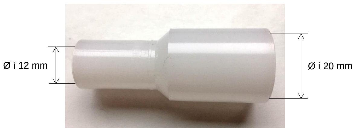
Bild 1. Skarvmuff för anslutning av 20 mm VP-rör till dosans 16 mm stuts.
